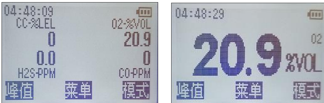
仪器常用气体浓度显示
